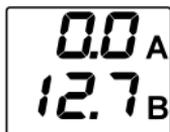
Диапазон измерения вольтметра: 8,5-32 В, точность  $\pm 0,1$  В
