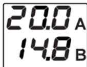
На экране отображается текущий ток и напряжение.
