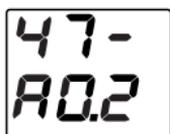
При подключении устройства к сети 220 В однократно отображается информация о номере модели ЗУ и версии прошивки.
