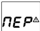
*При неправильном подключении ЗУ отключается от аккумулятора, на экране замигают надпись "ПЕР" и значок тревоги. После отсоединения клемм ЗУ от аккумулятора работоспособность ЗУ автоматически восстанавливается.*
