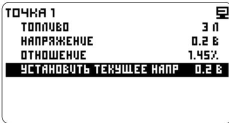
Прибор записывает измеренное значение сигнала уровня на датчике уровня топлива в память. В строке **Напряжение** отображается напряжение измеряемое на датчике уровня топлива, в строке **Отношение** отображается отношение напряжения на датчике уровня топлива к напряжению бортовой сети.
