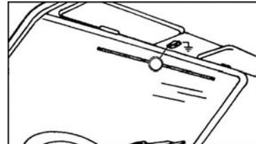
4. Закрепите шлейф заземления (короткий провод) под винт держателя зеркала или солнцезащитного козырька, либо к очищенному до металла месту корпуса автомобиля. Обратите внимание на обеспечение устойчивого контакта с корпусом автомобиля, т.к. от этого зависит качество работы антенны.
