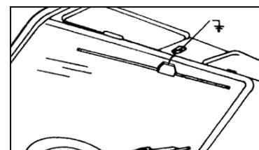
4. Закрепите шлейф заземления (короткий провод) под винт держателя зеркала или солнцезащитного козырька, либо к очищенному до металла месту корпуса автомобиля. Обратите внимание на обеспечение устойчивого контакта с корпусом автомобиля, т.к. от этого зависит качество работы антенны.
